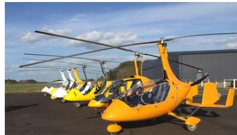
La masse maximale au décollage d'un autogire monoplace est de 330 kg. La MTOM d'un biplace est de 500 kg. La charge rotorique à la MTOM se situe entre 5 et 12 kg au m<sup>2</sup> à la masse maxi, à comparer à la charge alaire d'un avion léger qui est plutôt de l'ordre de 60 à 70 kg/m<sup>2</sup>.
