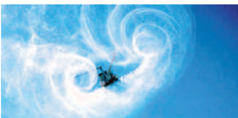
Visualisation de la turbulence de sillage générée par un hélicoptère.
