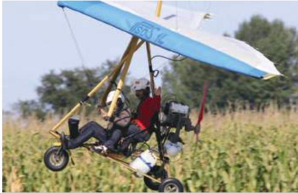
▲ © Air-ULM - De tous les appareils de l'aviation légère et ultralégère, le pendulaire bénéficie du système de commande le plus simple: le pilote agit directement sur l'aile en déplaçant le trapèze.
