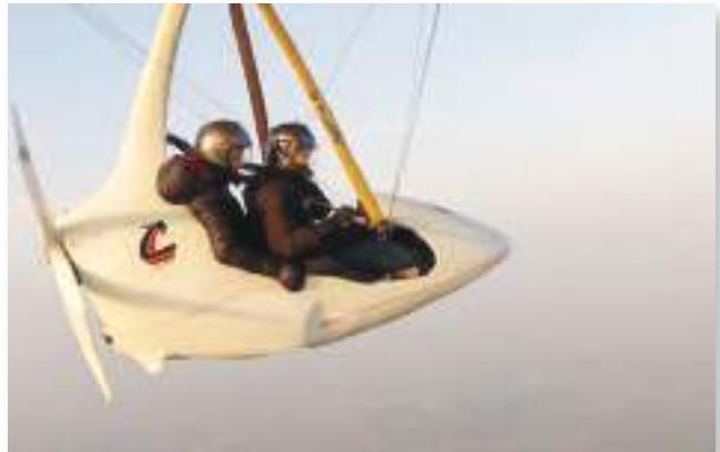
▲ Le Cosmos C, une proposition restée sans suite de biplace composite à train rentrant mue par un Rotax 503 en 1988.
