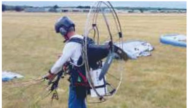
**P**lus silencieux qu'un paramoteur classique, le paramoteur électrique profite aussi de la fiabilité et de la propreté des moteurs électriques. Plébiscitée par les parapentistes, cette motorisation offre l'avantage de pouvoir être totalement arrêtée en vol et de redémarrer en toute sécurité pour exploiter les conditions thermiques.
