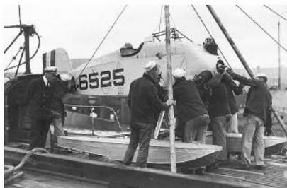
◀ Le Glenn-Martin MS-1 en cours d'assemblage sur le sous-marin SS-105.
