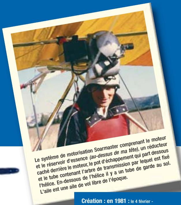
Le système de motorisation Soarmaster comprenant le moteur et le réservoir d'essence (au-dessus de ma tête), un réducteur caché derrière le moteur, le pot d'échappement qui part dessous et le tube contenant l'arbre de transmission par lequel est fixé l'hélice. En-dessous de l'hélice il y a un tube de garde au sol. L'aile est une aile de vol libre de l'époque.
