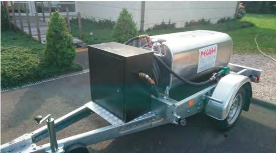
Réservoir alu 333 litres agréé UN1203 sur remorque galva ; armoire métal renfermant pompe atex 50 L /min, volucompteur, filtre aviation, flexible et pistolet automatique.
